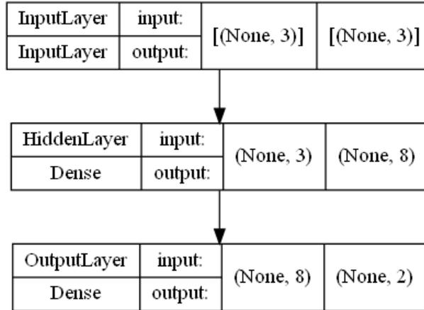
Рис. 1. Схема нейронной сети аппроксимации функции  $F$  для квадратного трёхчлена
