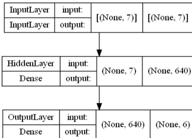
Рис. 2. Схема нейронной сети аппроксимации функции  $F$  для полинома 6-й степени
