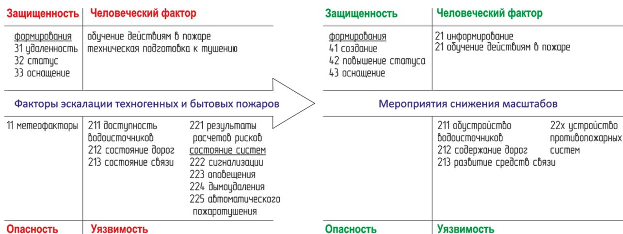
Рис. 2. Схема управления риском эскалации пожаров
