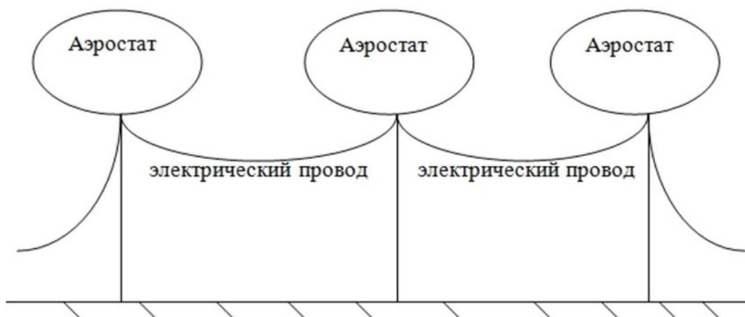
Рис. 1. Схема временной воздушной линии электропередачи
